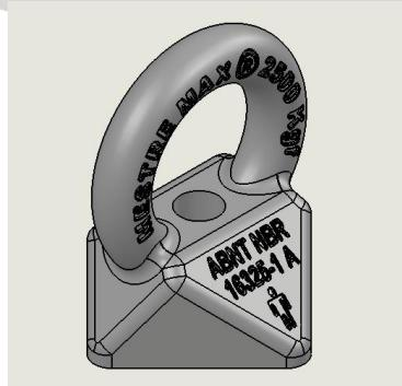
Deve-se verificar através do tato e/ou de forma visual a conformidade da fixação do ponto de ancoragem, aparecimento de trincas, deformações plásticas, alteração da cor característica, desgaste ou outra condição que possa comprometer o dispositivo.
